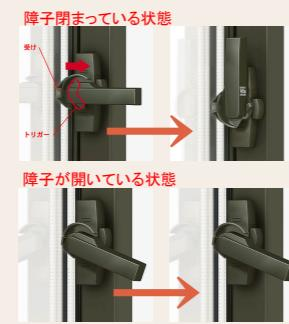
トリガーが受けに押され、ロックが解除されると、クレセントが回り施錠されます。
