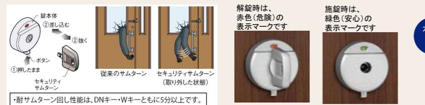
ボタンを押して、抜くだけでサムターンが取り外せる「セキュリティサムターン」を採用。外出時や就寝時に外しておけば、ガラスを割られて手を入れられても、サムターンがないので開けられる心配がありません。同時に、シリンダー付近に穴をあけ針金で解錠する「サムターン回し」も防ぐことができます。
